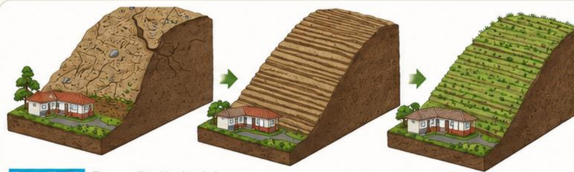
Ilustración 25. Revegetalización de taludes
